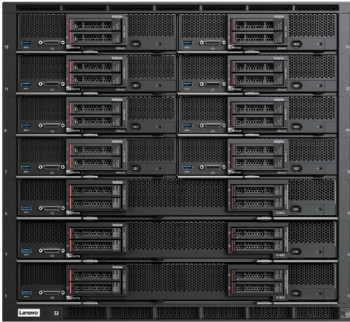
Flex System 企业级机箱可容纳 7 个 SN850 计算节点，实现较高的密度
